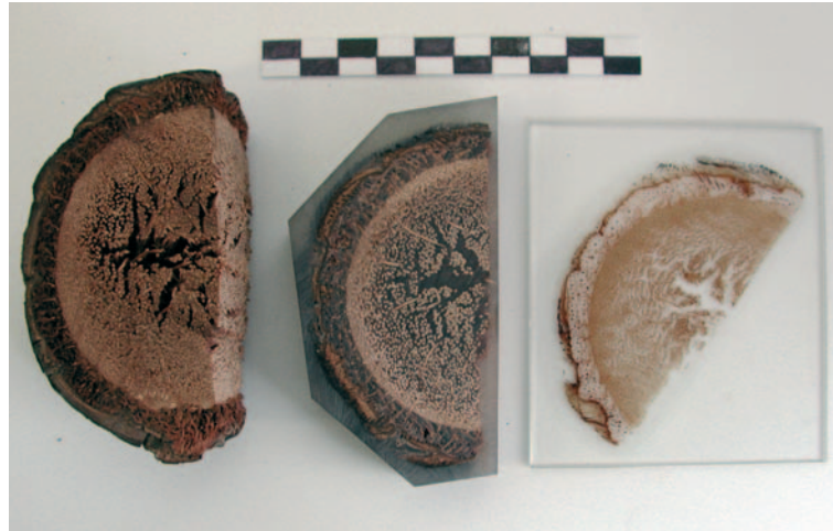
FIGURE 4.1 – Exemple d'inclusion dans la résine polyester.
